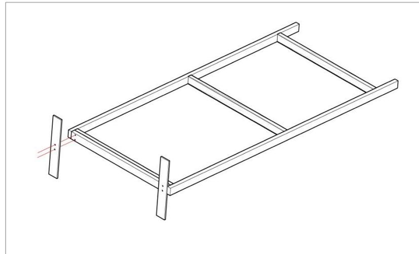
**1:** Atornillar las patas, colocando la cara con los taladros avellanados hacia abajo, para que los tornillos queden enrasados en la chapa y no sobresalgan
