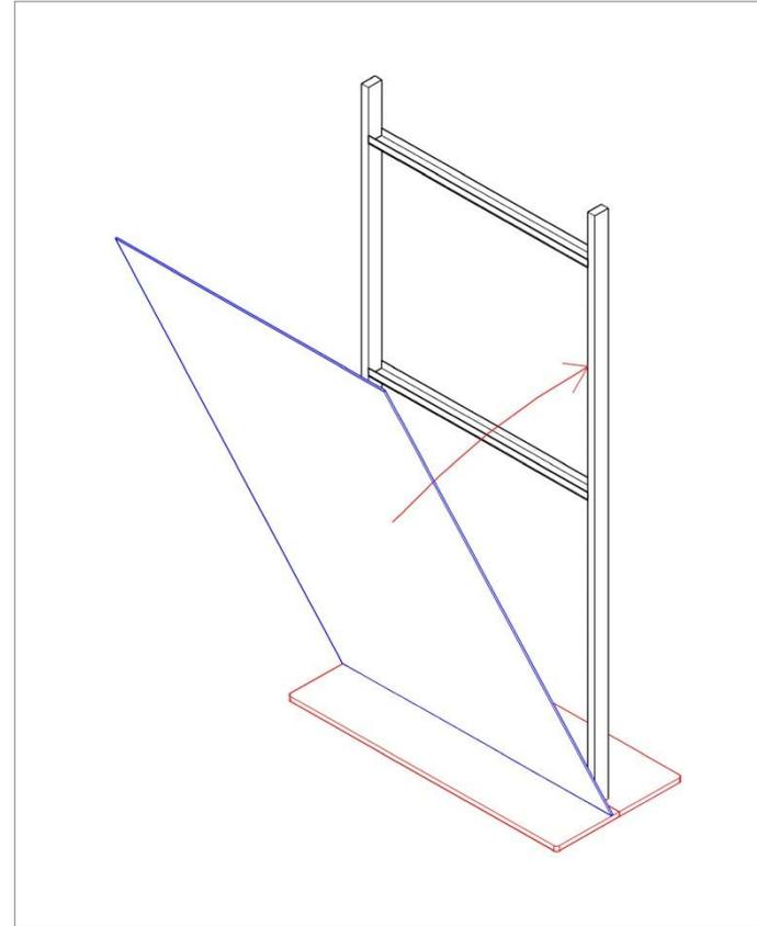
3: Colocar las 2 láminas cerámicas alineadas con los lados de la estructura de hierro, utilizando silicona y cera caliente.
