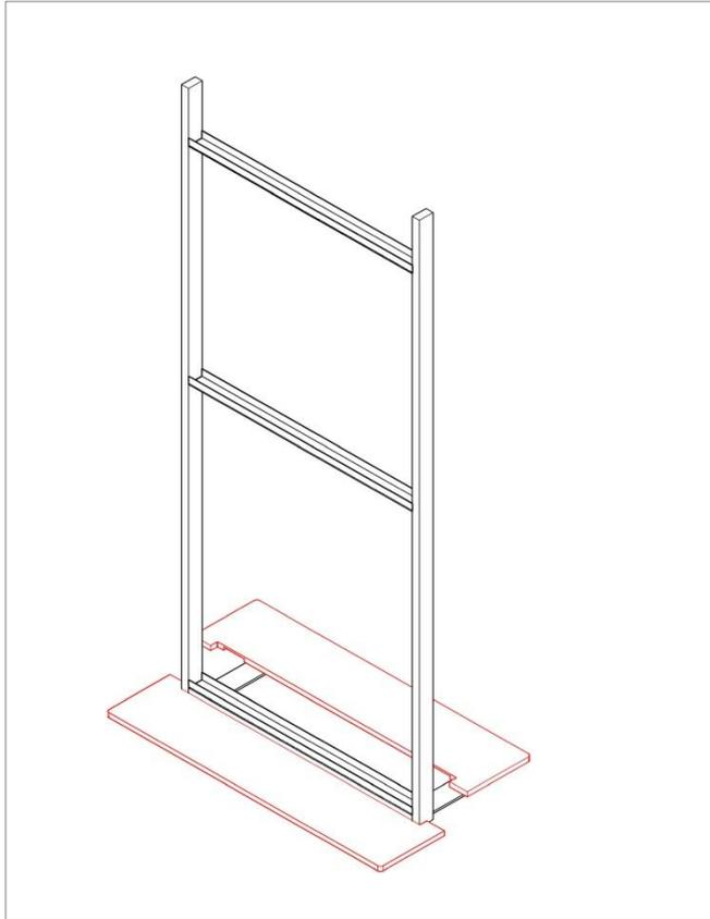
2: Ya en el emplazamiento definitivo, colocar las 2 bases de madera lacada, con unas gotas de silicona en las patas
